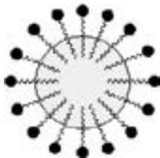
Schema di una micella di tensioattivo. Le molecole di tensioattivo sono situate all'interfaccia delle due fasi. La fase oleosa (ad esempio una goccia di olio) è rappresentata dal cerchio grigio, circondato dalle molecole di tensioattivo, a loro volta circondate dalla fase acquosa (in bianco).
